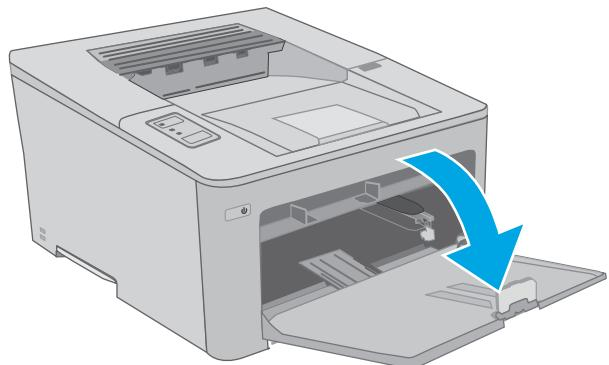
2. Отрегулируйте ограничитель ширины бумаги: нажмите на регулировочные защелки на правой направляющей и сдвиньте ограничители по формату используемой бумаги.
